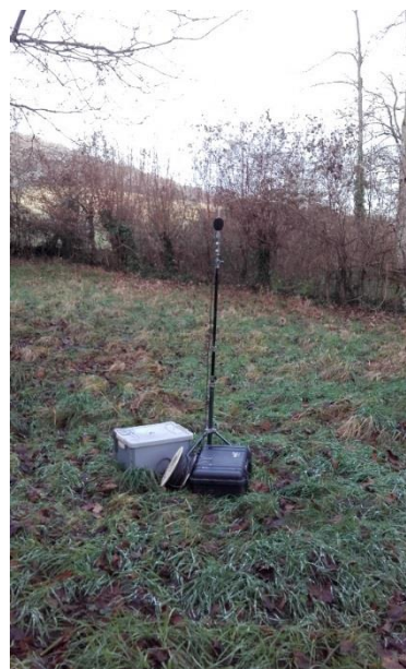
Emplacement du microphone pour la mesure au point 5
