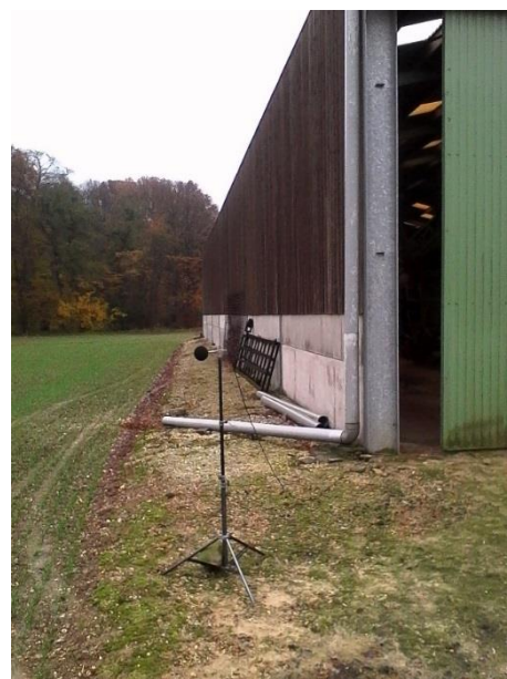
Emplacement du microphone pour la mesure au point 6
